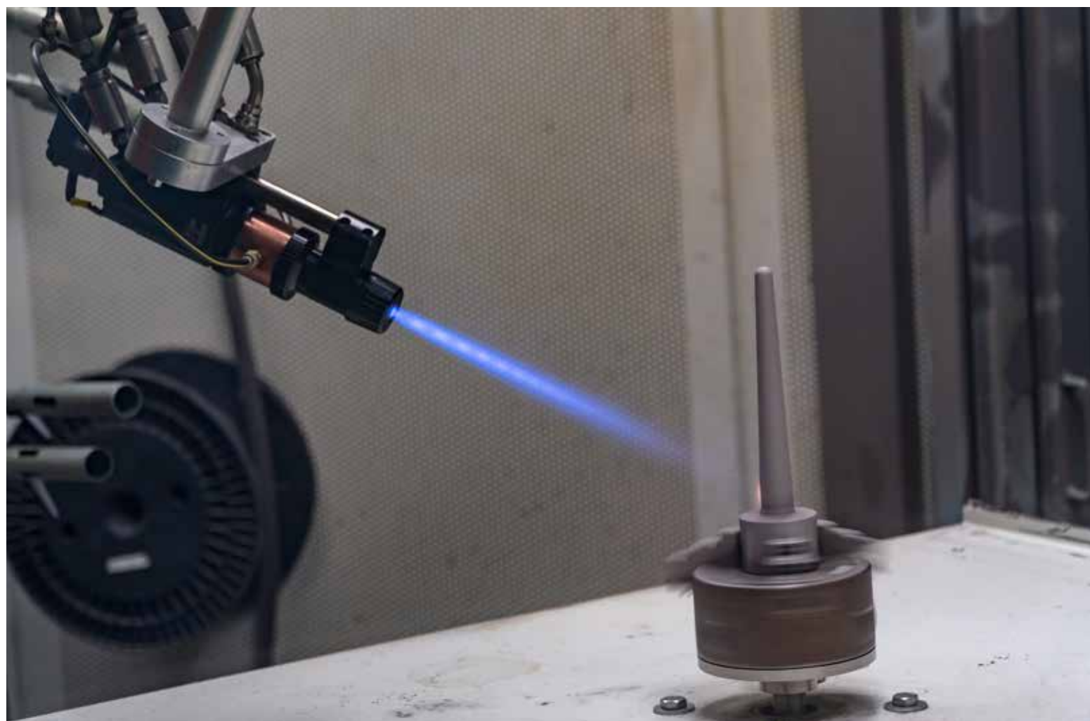
Thermisch spuiten met een HVOF-gun.
